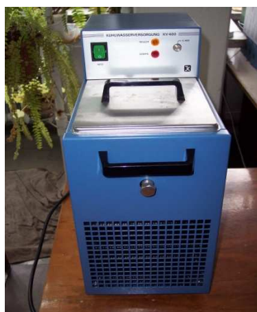
Termostat chłodzący KV400 –nr 10.003641
