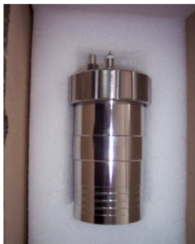
Bomba kalorymetryczna IKA-C 1,8-szt.2 -nr10.003828, 10003821
