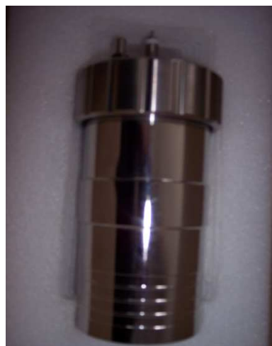
Bomba kalorymetryczna IKA-C 1,8-szt.2 -nr10.003828, 10003821
